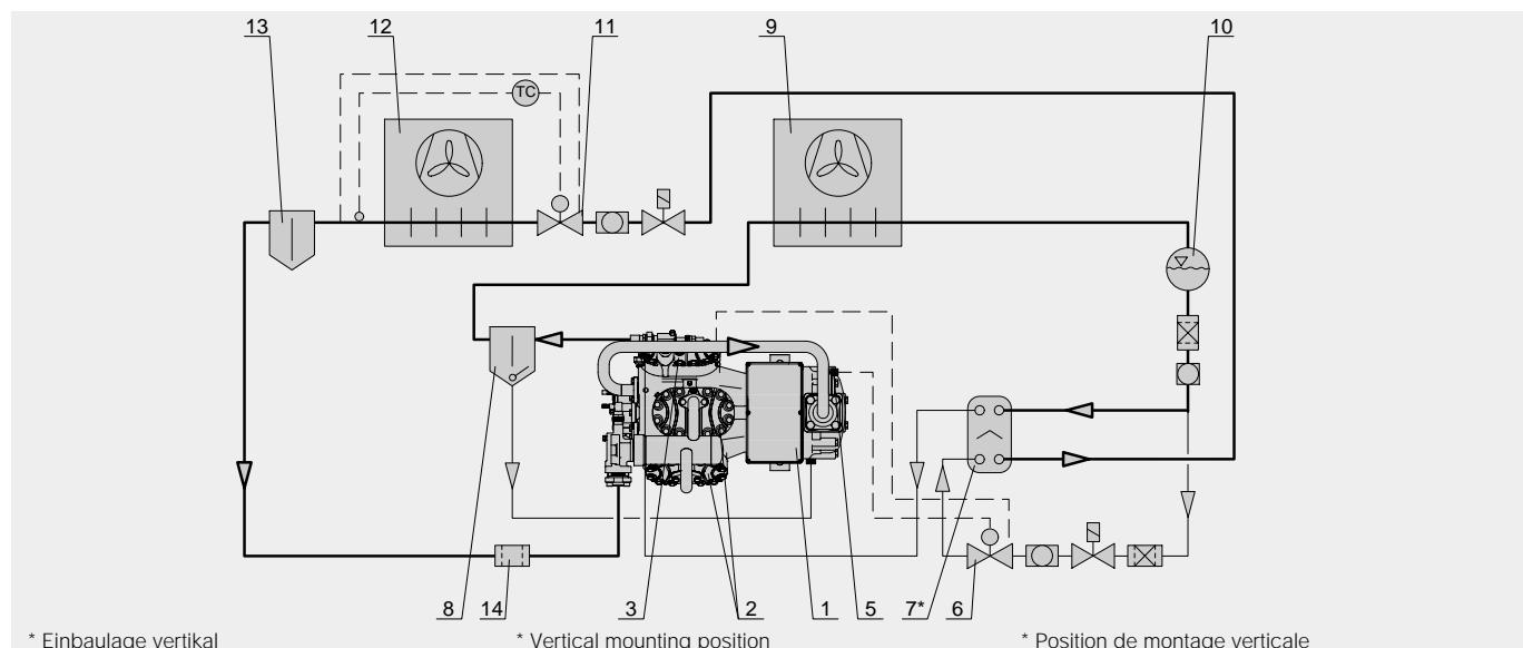
**2-stufiges System mit Kältemittel-Unterkühler – Zwischenkühlung mit elektronischem **CIC®**-System**
